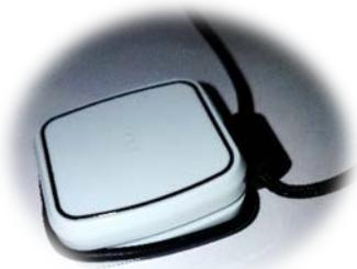
Ziehen Sie das untere Ende des „Rahmens“ der Halskordel auf den Vibby. Stellen Sie sicher, dass der „Rahmen“ in die Rinne im Gehäuse des Vibby eingesetzt wird.
