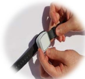
Ziehen Sie den „Rahmen“ des Armbands über den Vibby, so dass der Rahmen in die Rinne des Vibby eingepasst wird.
