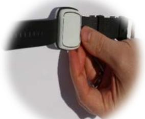
Führen Sie die Befestigungsnasen in die entsprechenden Aussparungen im Gehäuse des Vibby ein, bis sie einrasten.
