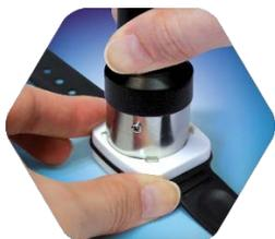
Öffnen Sie den Batteriefachdeckel, indem Sie ihn mit dem Batteriewechsel-Tool eine Viertel-Umdrehung gegen den Uhrzeigersinn drehen.
