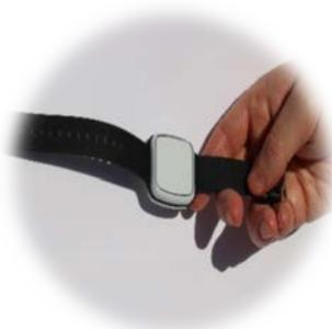
Ziehen Sie das Armband vorsichtig nach unten, um zu simulieren, dass der Vibby am Handgelenk getragen wird. Dadurch wird getestet, ob die Befestigungsnasen korrekt in den Aussparungen sitzen.
