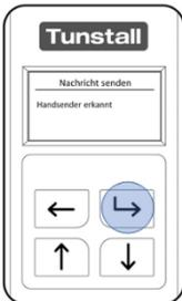
Der Universalsensor zeigt an, welche Funknachrichten er senden kann. Die zur Verfügung stehenden Meldungen hängen davon ab, in welcher Betriebsart der Universalsensor arbeitet, d.h. was im Auswahlmodus eingestellt ist. Um die markierte Meldung zu senden, drücken Sie die Auswahl-taste. Um das Menü zu verlassen, ohne eine Nachricht zu senden, drücken Sie die Zurück-Taste.
