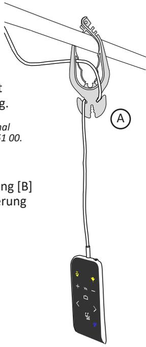
Zur Aufbewahrung in der Halterung [B] das ePat<sup>lite</sup> von oben in die Halterung hereinschieben:
