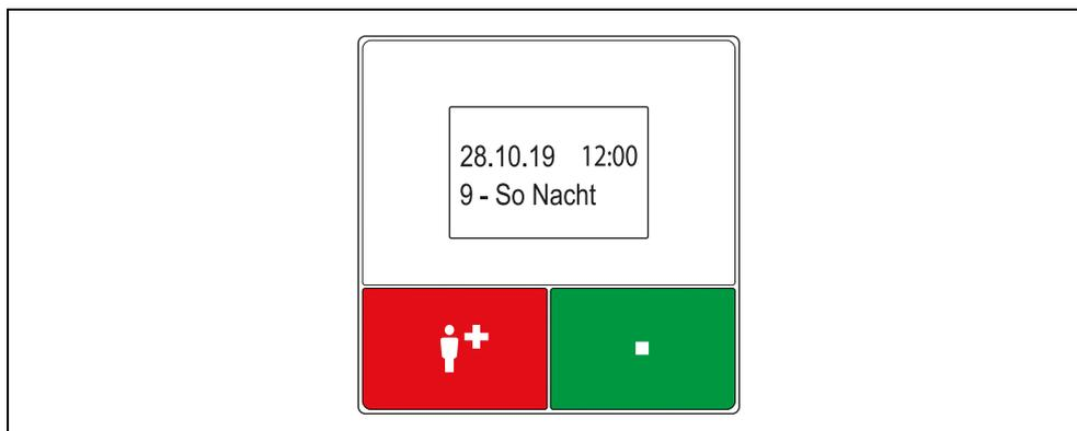
Abb. 20: Raumsteuerung mit Display im Dienstzimmer, Standby-Anzeige
