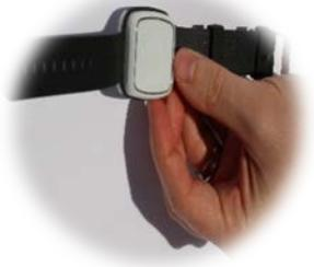
Führen Sie die Befestigungsnasen in die entsprechenden Aussparungen im Gehäuse des Vibby ein, bis sie einrasten.
