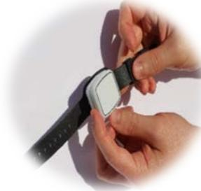
Ziehen Sie den „Rahmen“ des Armbands über den Vibby, so dass der Rahmen in die Rinne des Vibby eingepasst wird.
