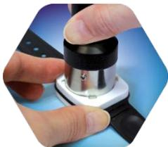
Verschließen Sie den Batteriefachdeckel, indem Sie ihn mit dem Batteriewechsel-Tool eine Viertel-Umdrehung im Uhrzeigersinn drehen.
