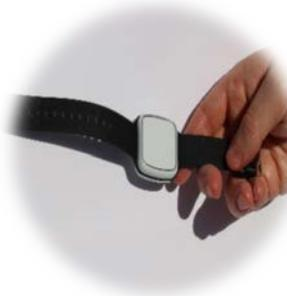
Ziehen Sie das Armband vorsichtig nach unten, um zu simulieren, dass der Vibby am Handgelenk getragen wird. Dadurch wird getestet, ob die Befestigungsnasen korrekt in den Aussparungen sitzen.
