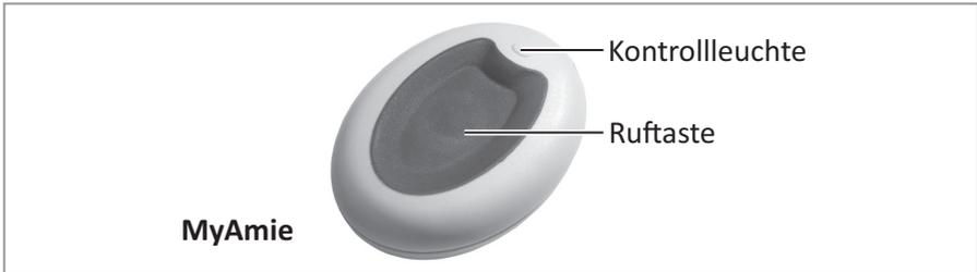
Die Kontrollleuchte am MyAmie bestätigt das Drücken der Ruftaste und zeigt gleichzeitig den Zustand der Batterie des MyAmie an:
