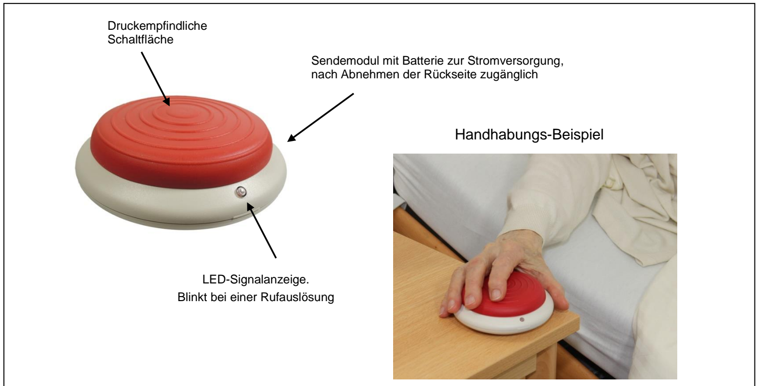
Bild 1: Funk-Balgtaster
