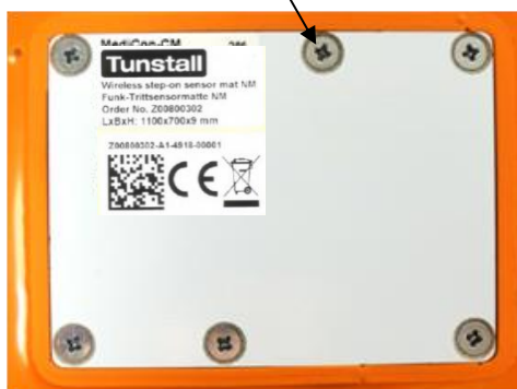
Abb. 1: Batterieabdeckung mit 6 St. Kreuzschlitzschrauben
