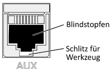
Der AUX-Anschluss aller Lifeline Vi Modelle ist seit Produktion März 2023 mit einem Blindstopfen ausgestattet. Der Blindstopfen dient als Berührungsschutz vor Kontakt mit elektrischem Strom.
